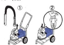
/ トラブル原因の 約7割は吸入弁の 固着なんだって!! 主な原因と対処法を ご説明いたします
